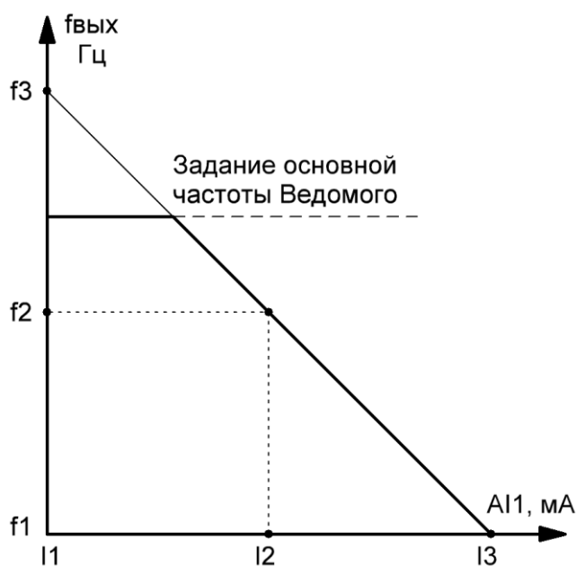
Рис.4. График задаваемой кривой зависимости (в нашем примере 2 – F06.07~F06.12) аналоговых входов Ведомого.
